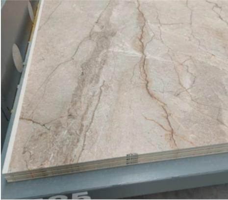
*Figura 9 Baldosas cerámicas obtenidas empleando subproductos LIFE REPLAY*
